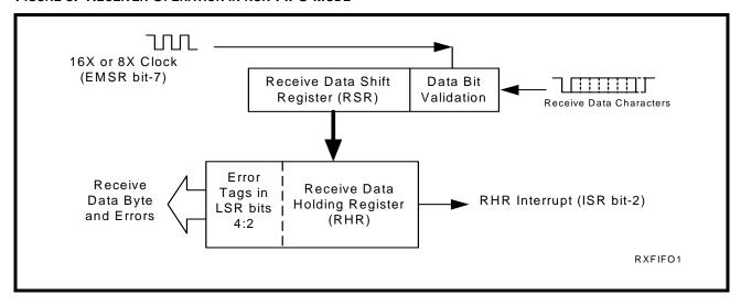
FIGURE 9. RECEIVER OPERATION IN FIFO AND AUTO RTS FLOW CONTROL MODE
