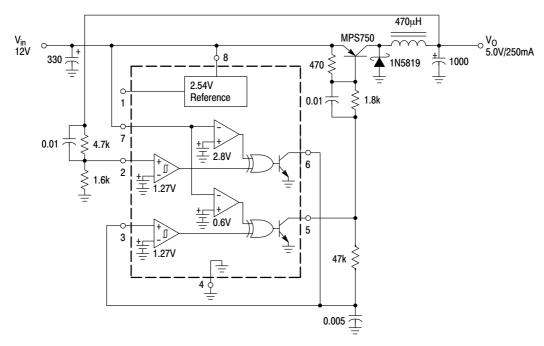
Figure 27. Step-Down Converter
