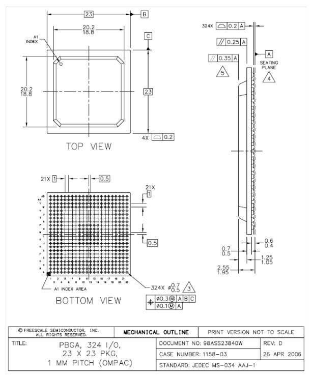
Figure 28. MPC5561 324 TEPBGA Package
