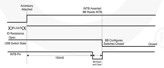
Figure 12. ID-Based Accessories, No V<sub>BUS\_IN</sub> Attach Timing<sup>(21)</sup>
