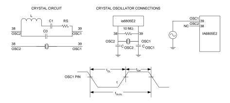
Figure 3. OSC1, OSC2 (System Clock)
