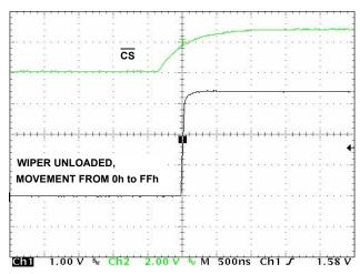
FIGURE 14. LARGE SIGNAL SETTLING TIME
