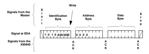
FIGURE 17. BYTE WRITE SEQUENCE
