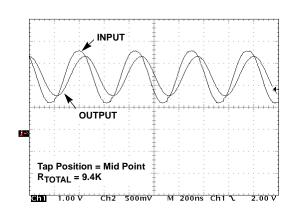
FIGURE 12. FREQUENCY RESPONSE (2.2MHz)
