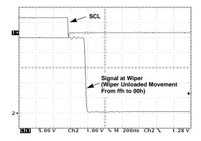
FIGURE 14. LARGE SIGNAL SETTLING TIME
