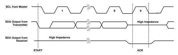
FIGURE 16. ACKNOWLEDGE RESPONSE FROM RECEIVER
